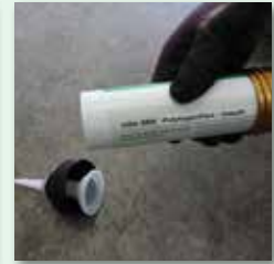
Kartusche in die Fließpistole einsetzen und verschließen
