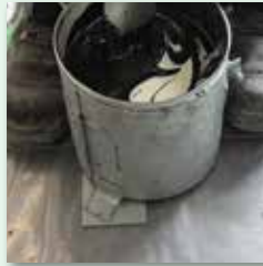
Dose im Gebindehalter arretieren und Inhalt mit dem Flügelrührer homogen vermischen
