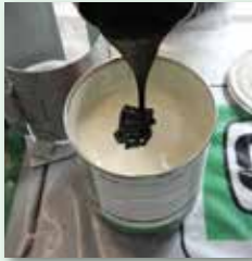
B-Komponente in die A-Komponente entleeren
