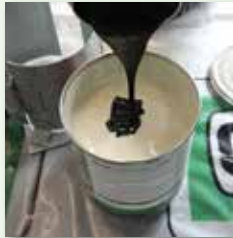
B-Komponente in die A-Komponente entleeren
